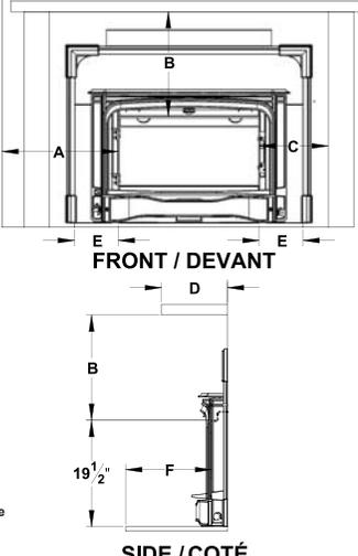
\* Measured from each side of the fuel loading and ash removal openings / Mesuré à partir de chaque côté de l'ouverture de la porte de chargement et du tiroir de cendre
