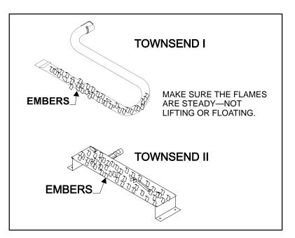
Figure 28. Burner Flame Patterns
