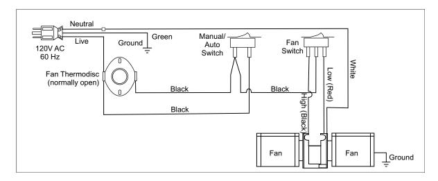
Blower / Fan Wiring Diagram
