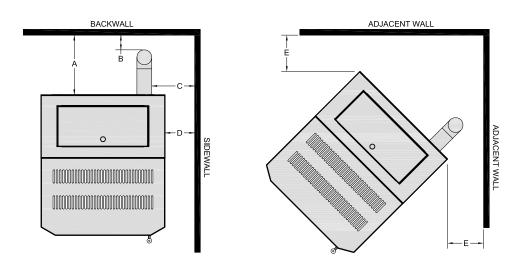
FIGURE 3 SIDEWALL / CORNER MINIMUM CLEARANCES
