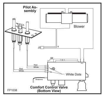
Fig. 59 Comfort Valve wiring diagram.
