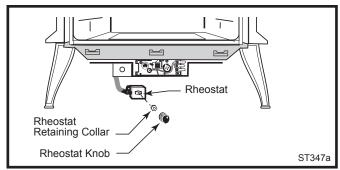
Fig. 18 Attach the fan rheostat.
